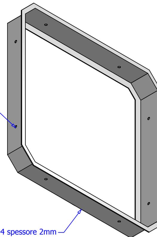
Lamiera in Acciaio inox Aisi 304 spessore 2mm
